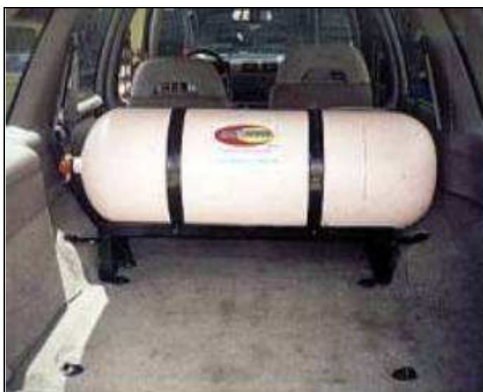
Figura 44 Cilindro de alta pressão de GN instalado
