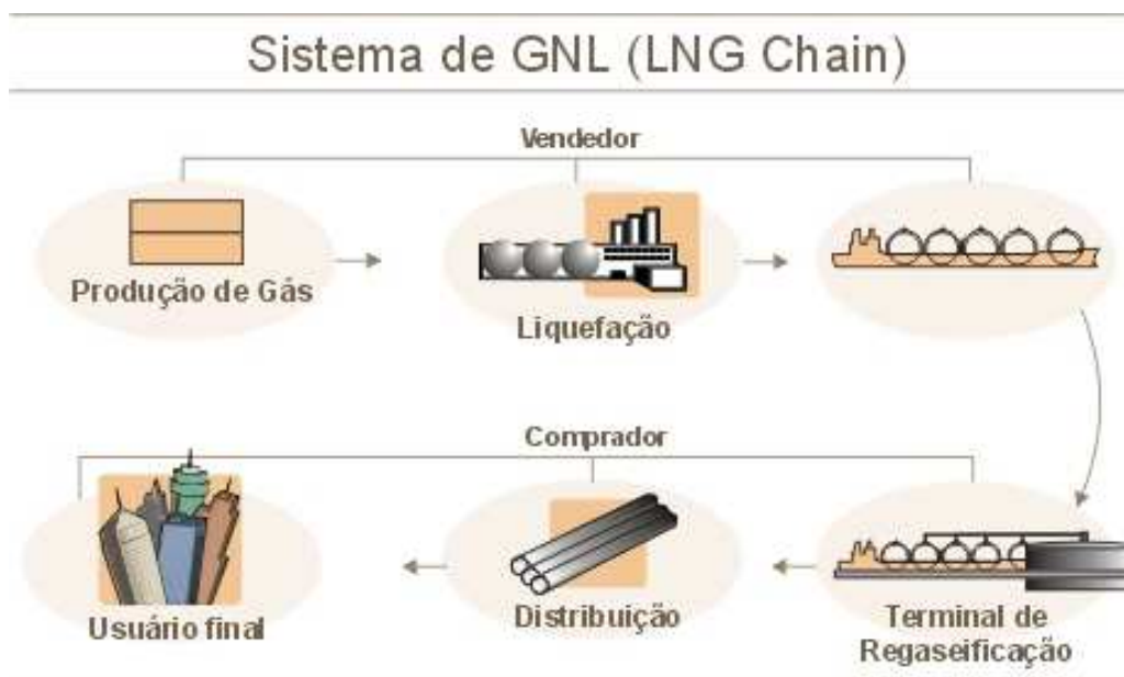
Figura 34 Esquema de movimentação do GNL Fonte: Luis Olavo Dantas, Projeto Gasnet, 2005, Curitiba, PR
