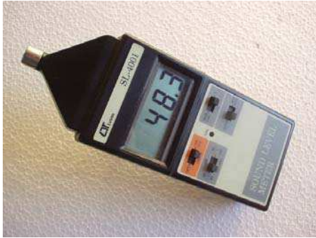
Figura 4. Medidor de nível de pressão sonora – decibelímetro
