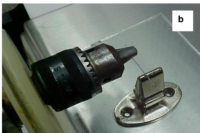
Figura 18 – (a) Troprômetro; (b) Detalhe da lima no equipamento
