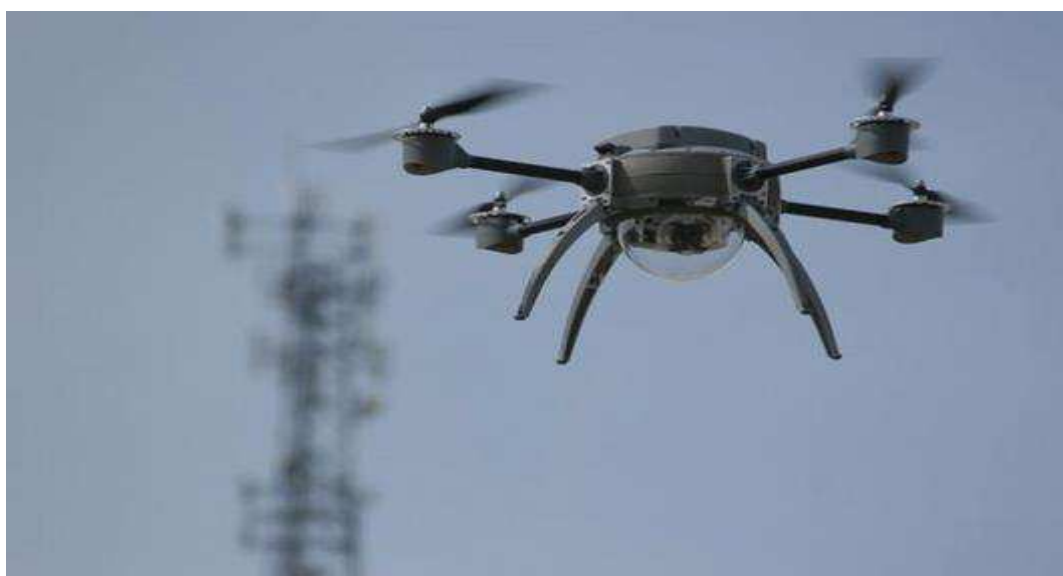
Figura 6 - Modelo de drone de quatro hélices com dispositivo de aerofotogrametria
