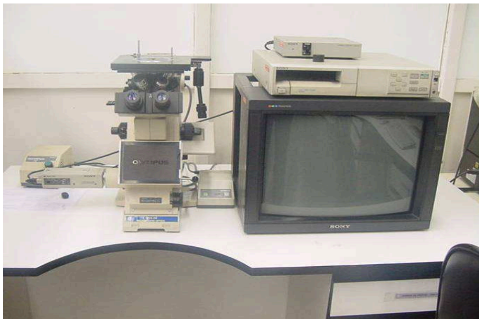
Figura 14 – Microscópio utilizado para análise da microestrutura do material, tirar fotos e gerar imagens
