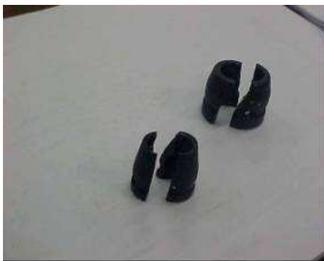
Figura 1 - Soquetes fraturados no sentido longitudinal a partir do fundo da estria.
