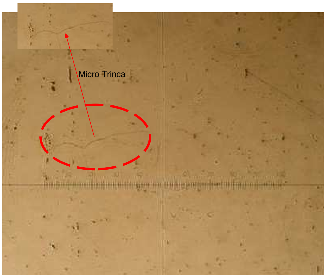
Figura 21 – Micrografia da amostra antes do alívio de tensão
