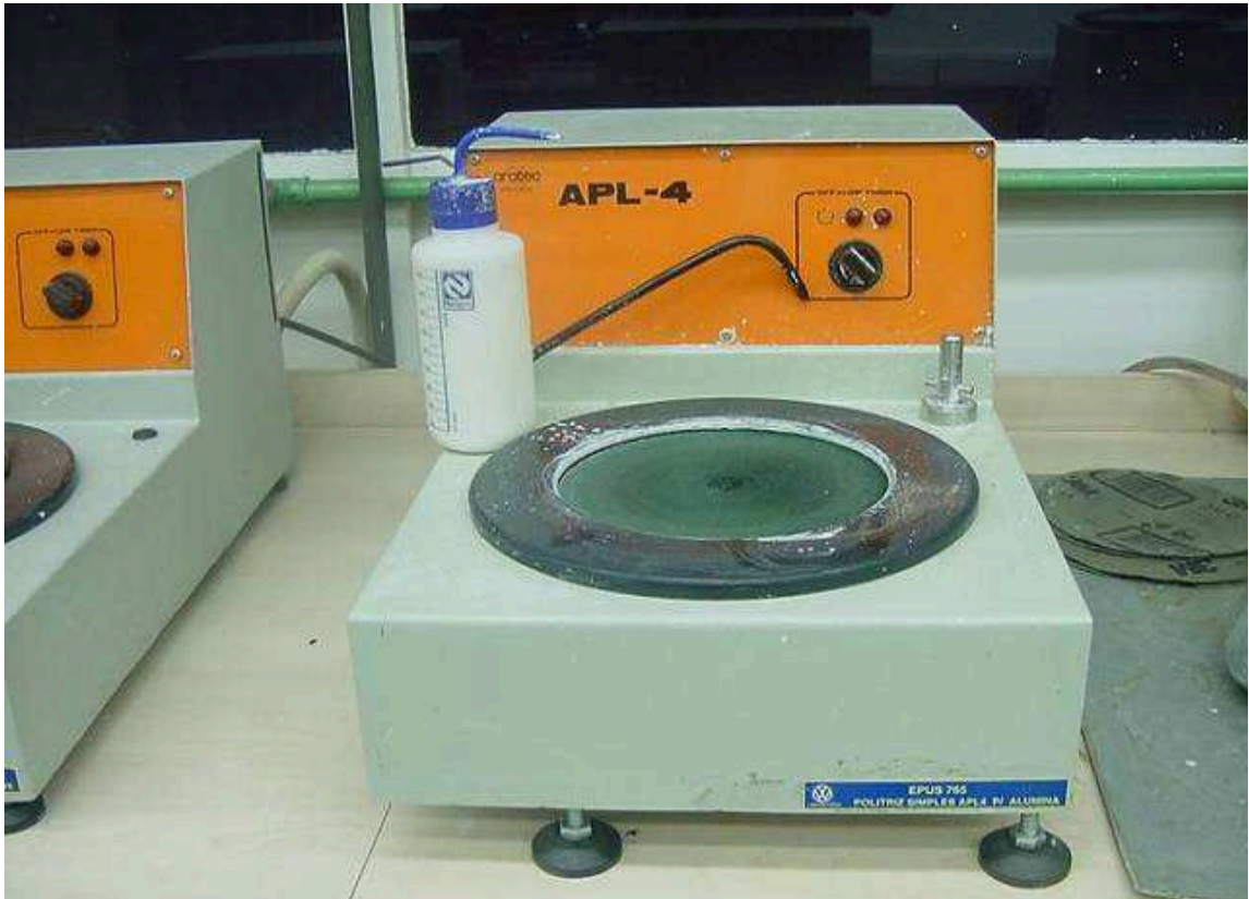
Figura 12 – Foto da politriz utilizada no polimento das amostras
