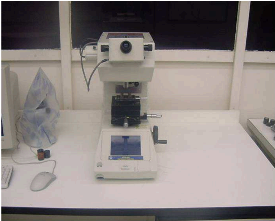
Figura 13 Microdurômetro utilizado na medição de dureza em Rockwell e Vickers
