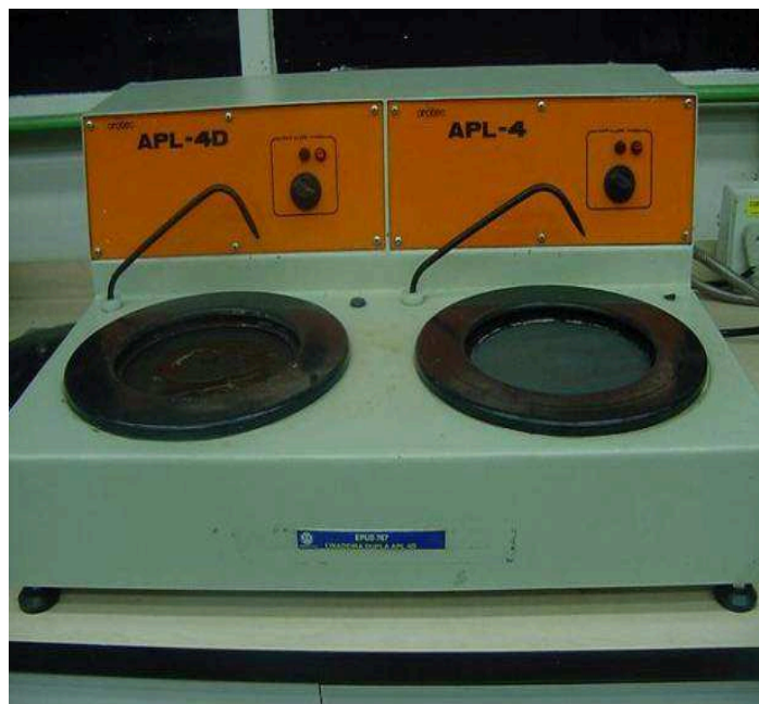
Figura. 11 – Politriz utilizada para lixamento
