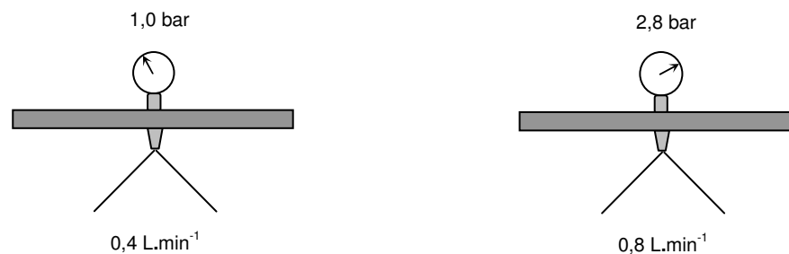
Figura 1.10 - Representação da Relação entre Pressão e Vazão no sistema de Pulverização.
