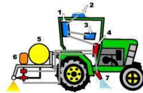
Figura 1.01 - Equipamento Terrestre de Pulverização com Tecnologia Embarcada para Aplicação em Doses Variáveis com Mapas Digitais, onde: 1) Receptor GPS; 2) Antena do GPS; 3) Computador de Bordo; 4) Sist. de integração da eletrônica de bordo; 5) Reservatório de água limpa; 6) Sistema de injeção direta de agroquímicos e 7) Sensor de velocidade (Radar).
