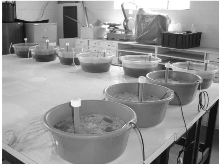
FIGURA 2. Sondas de TDR e extratores de solução instalados nos recipientes plásticos com solo.
