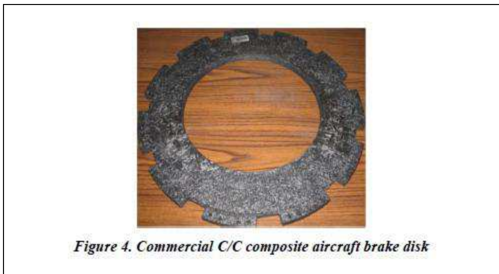
Figura 3 – Amostra de Disco de Freios de uma aeronave comercial de compósito C/C. Fonte: Chu, Filip e Poudel , 2012.
