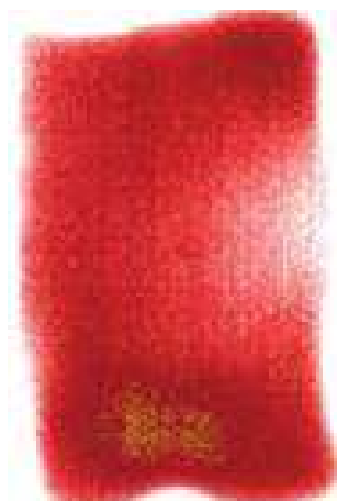
Figura 9 - Termograma após aquecimento por 16s do corpo de prova de matriz termoplástica de polisulfeto de fenileno. Pode-se notar uma pequena mancha escura, caracterizando o dano provocado por um impacto de 5J (Fonte: José R. Tarpani, Euripedes G. R. de Almeida, Éder C. A. Simêncio, Lucas P. Mota, , Jaime H. A. A. Paz, Alan R. M. Gualberto, Felipe L. A. Cardoso, Cristina A. Gatti, 2009).
