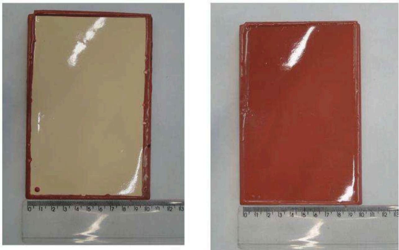
Figura 11 - Corpo de prova com revestimento A (esquerda) e B (direita) (Extraído de Grosso, 2011).
