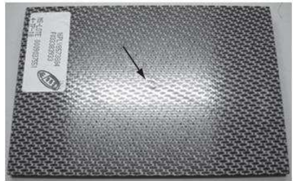
Figura 7 - Marca causadas por impacto de 5J em matriz termorígida epóxi (esquerda) e matriz termosplástica de polisulfeto de fenileno (direita) (Fonte: José R. Tarpani, Euripedes G. R. de Almeida, Éder C. A. Simêncio, Lucas P. Mota, , Jaime H. A. A. Paz, Alan R. M. Gualberto, Felipe L. A. Cardoso, Cristina A. Gatti, 2009).
