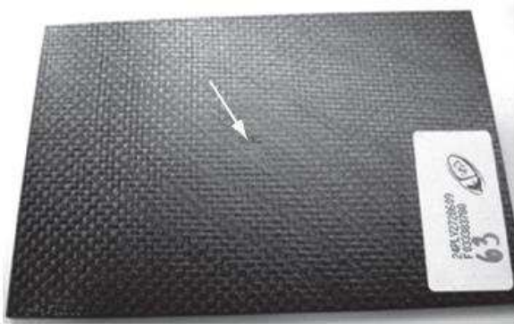
Figura 7 - Marca causadas por impacto de 5J em matriz termorígida epóxi (esquerda) e matriz termosplástica de polisulfeto de fenileno (direita) (Fonte: José R. Tarpani, Euripedes G. R. de Almeida, Éder C. A. Simêncio, Lucas P. Mota, , Jaime H. A. A. Paz, Alan R. M. Gualberto, Felipe L. A. Cardoso, Cristina A. Gatti, 2009).
