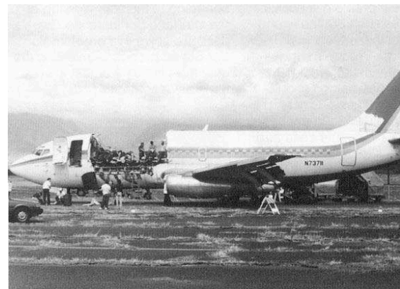
Fig. 2-2 Falha por fadiga, aeronave B737 – 200.
