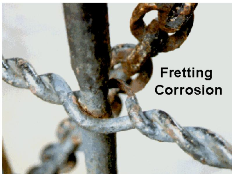
Figura 8 - Corrosão por atrito (Fretting)
