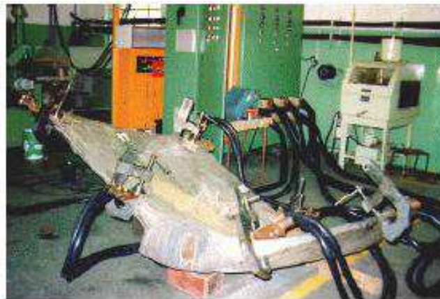
Figura 5 Ensaio por partículas magnéticas usando Método Multidirecional de Magnetização (ANDREUCCI, 2009).
