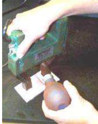
Figura 12 Aplicação do pó via seca (ANDREUCCI, 2009).
