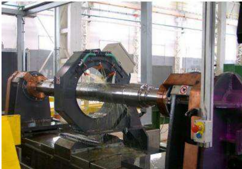
Figura 13 Aplicação do pó via úmida (ANDREUCCI, 2009).
