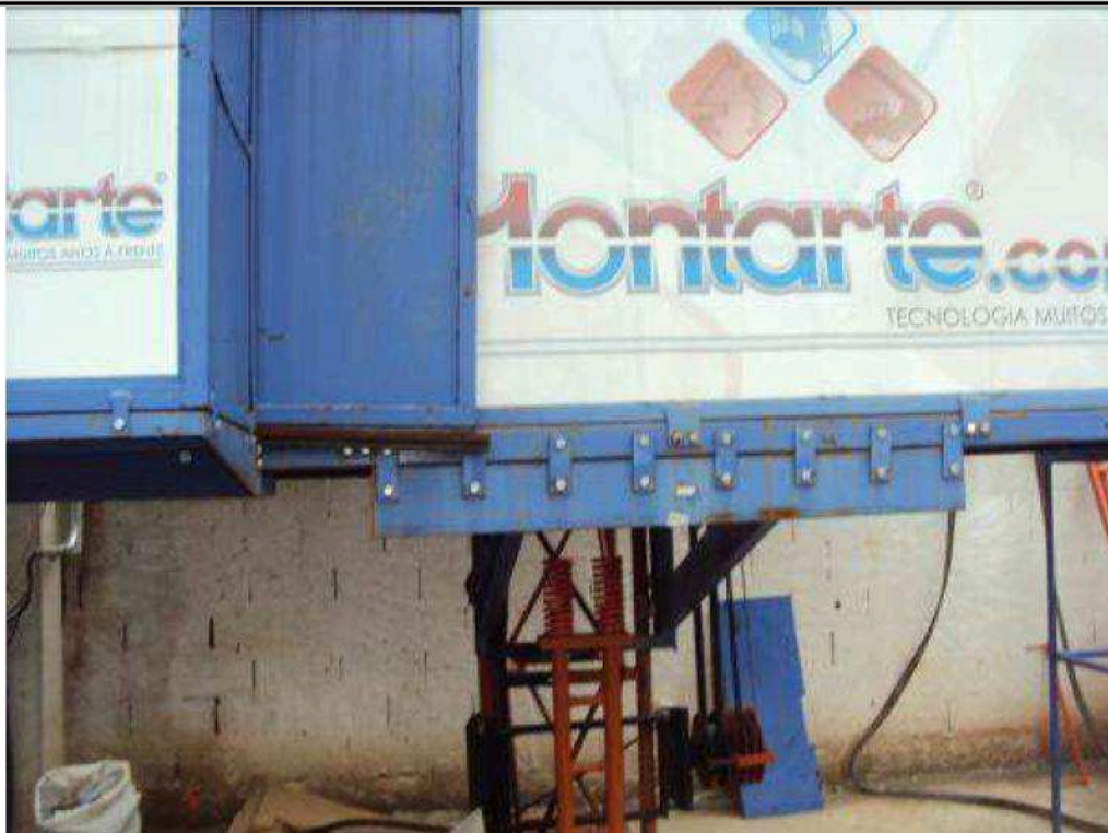
Figura 6 - Estrutura do montante, região onde foram posicionados os strain-gages 10,11, 12, 13 e 14.
