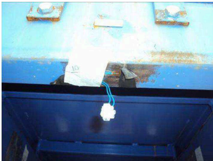
Figura 7 – Estrutura com a posição do strain-gage 10.
