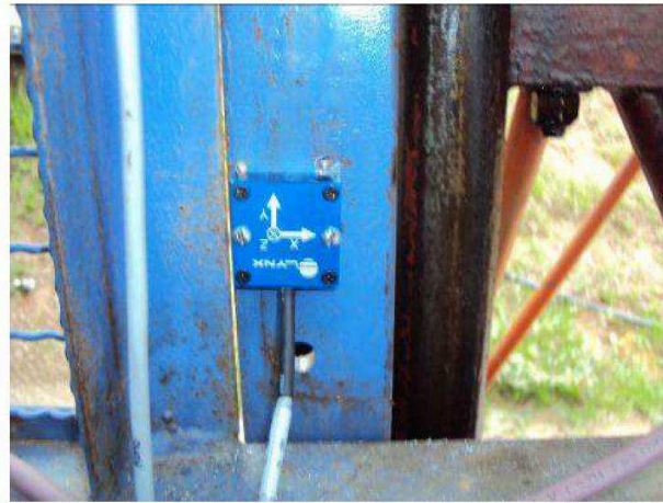
Figura 4 - Detalhe da posição do acelerômetro 2 (900 mm abaixo do freio).
