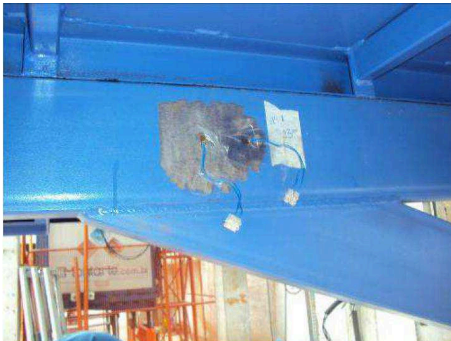
Figura 9 – Estrutura instrumentada com os strain-gages 13 e 14.
