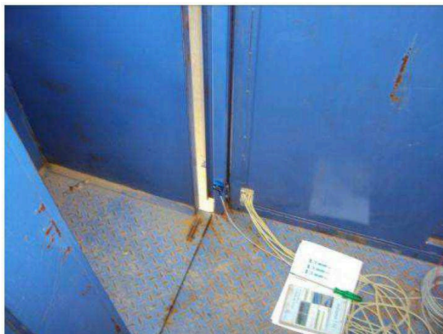
Figura 5 - Posição do acelerômetro 3 (parte inferior interna da cabine)
