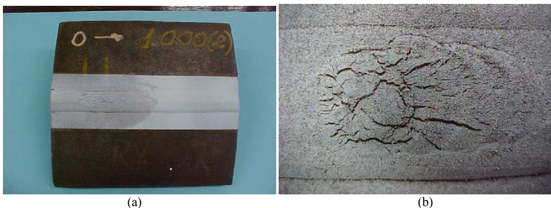
Figura 4 – (a) Corpo-de-prova – 1,000" (25,4 mm). (b) Região de trincas detectadas por PM.
