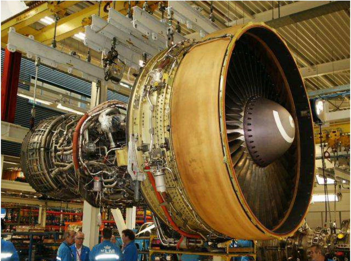
Figura 1 - LM 6000 é um motor estacionário derivado do seu “irmão” aeronáutico CF6 50. Sua aplicação se dá em unidades de produção de energia termo elétricas.
