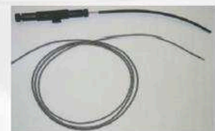
Figura 4 – Boroscópio com visor em alta definição com possibilidade de realizar medições, filmagens, fotografias e sondas flexíveis.
