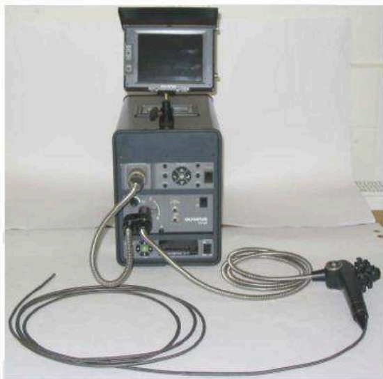
Figura 4 – Boroscópio com visor em alta definição com possibilidade de realizar medições, filmagens, fotografias e sondas flexíveis.
