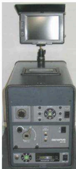
Figura 4 – Boroscópio com visor em alta definição com possibilidade de realizar medições, filmagens, fotografias e sondas flexíveis.
