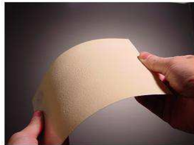
Figura 7. Tinta piezoelétrica numa folha de alumínio (Zhang, 2007)
