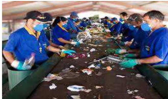
Figura 7 Esteira de segregação Fonte: Soluções industriais, 2013.
