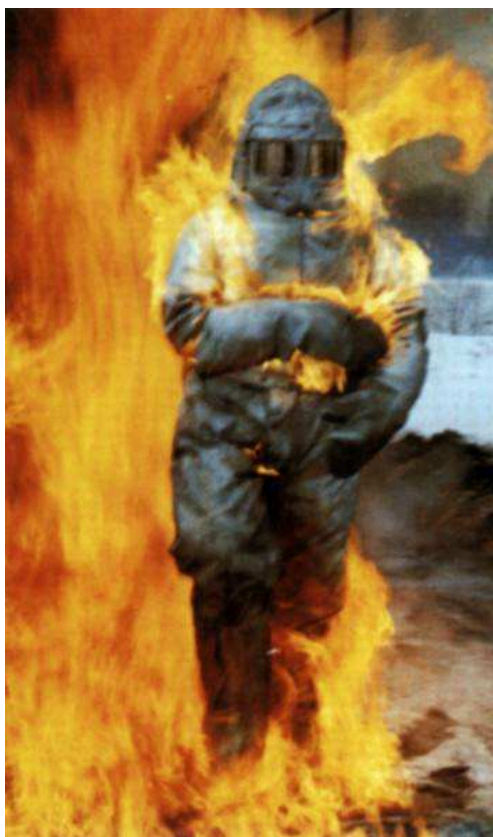
Figura 3 Teste em vestimentas de proteção Fonte: Engesel, 2018
