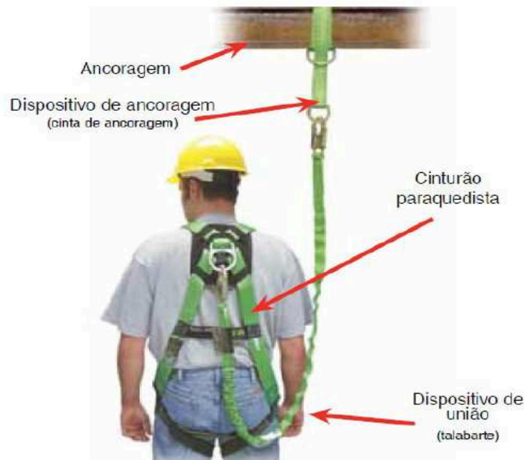
Figura 7 Sistema de ancoragem
