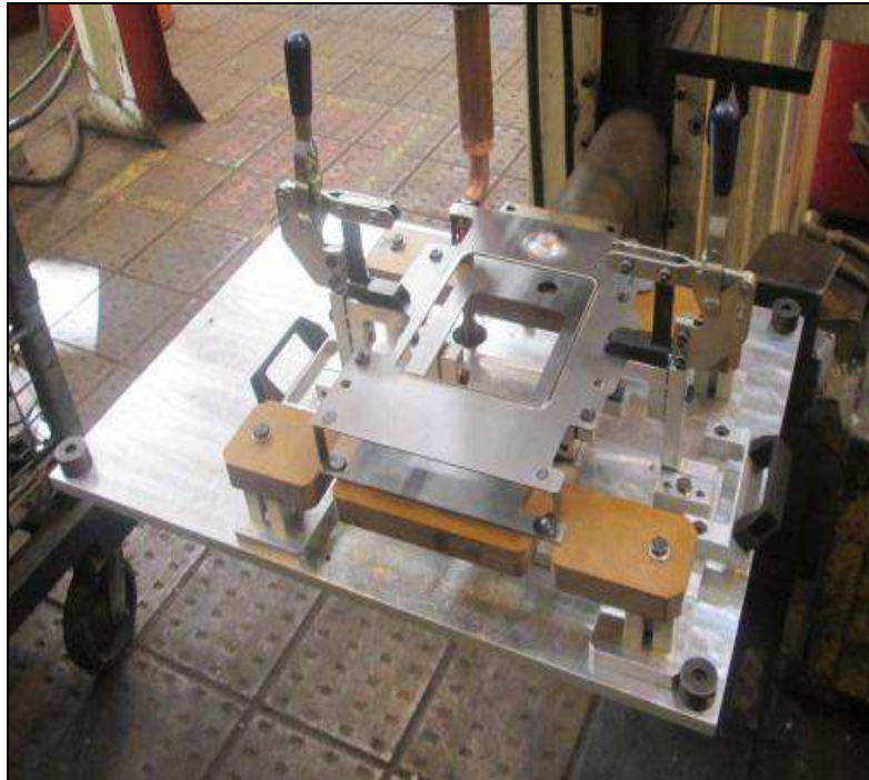
Figura 9 – Operador ajustando a chapa 2 para a soldagem, formando o suporte.
