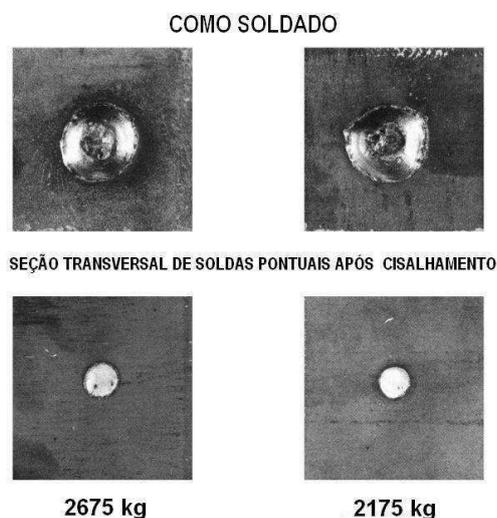
Figura 10 - Resistência ao cisalhamento (ESAB MIG)
