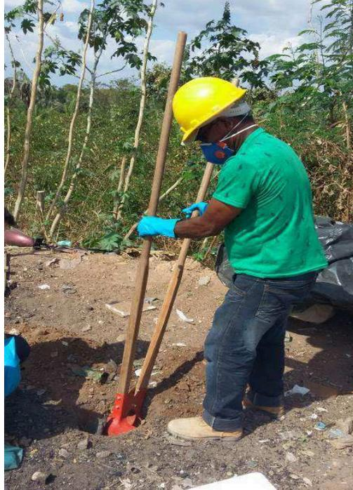
**Figura 7** - Escavação para retirada de amostras do solo do lixão do município de Augustinópolis, Tocantins, julho de 2016.
