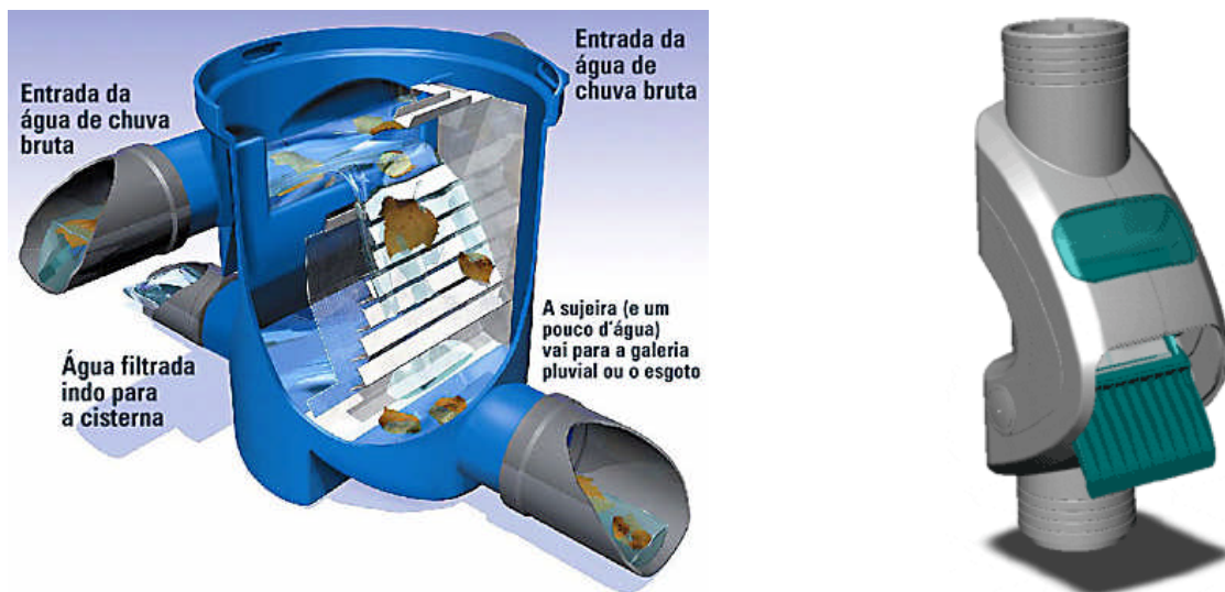
Fig. 3.3 - Filtro Volumétrico e filtro para descida do tubo vertical (Fonte: 3P Technic)
