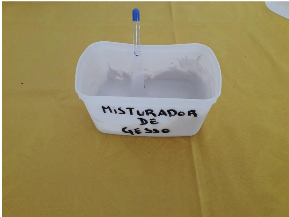
Figura 27 – Massa de gesso misturada e pronta para ser inserida no pote 2
