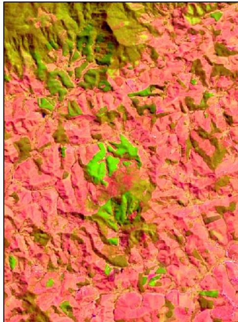
Figura 4: Imagem de satélite ajustada espectralmente para destacar o eucalipto em verde claro nas três bandas RGB-654.
