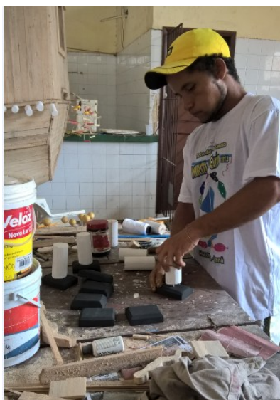
Figura 25 - Trabalhador em contato com tintas, colas e particulados sem uso de EPI.
