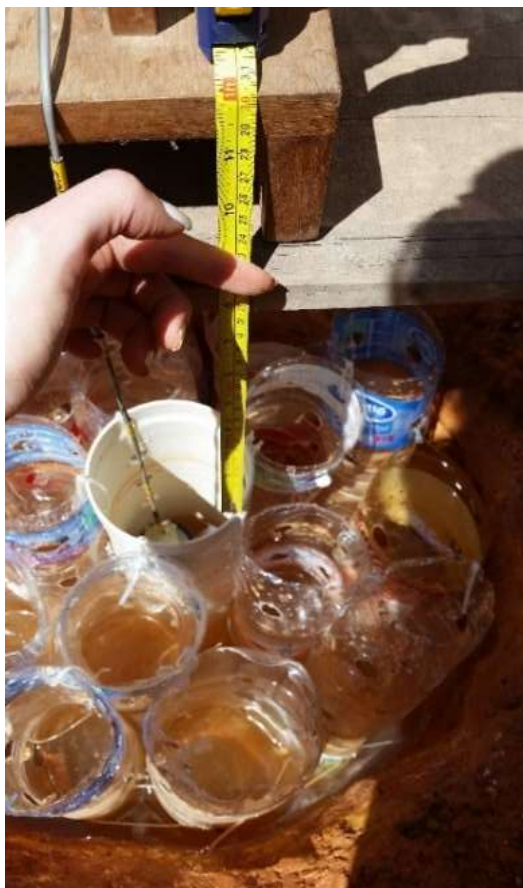
Figura 20: Diferença de altura de 30 cm entre o equipamento e o sumidouro
