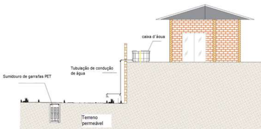
Figura 17: Figura esquemática da localização da caixa d'água, tubulação e sumidouro ao lado da área edificada
