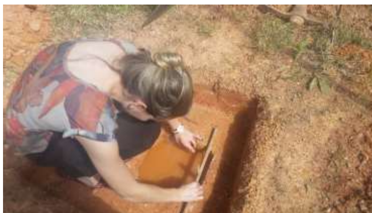
Figura 12: Execução da medição do abaixamento de 1 cm de água (água que irá infiltrar no solo). Observou-se que o tempo gasto para esta percolação foi de 2,4 minutos para a infiltração.
