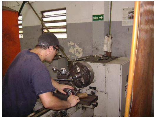
Figura 5 - (a) Ajuste da peça ao torno; (b) fixação da peça ao torno; (c) processo de usinagem Fonte: Braga, 2007.
