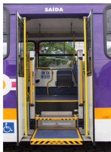
Figura 32: Plataforma de Acesso Fonte: ABC Transporte (2015)
