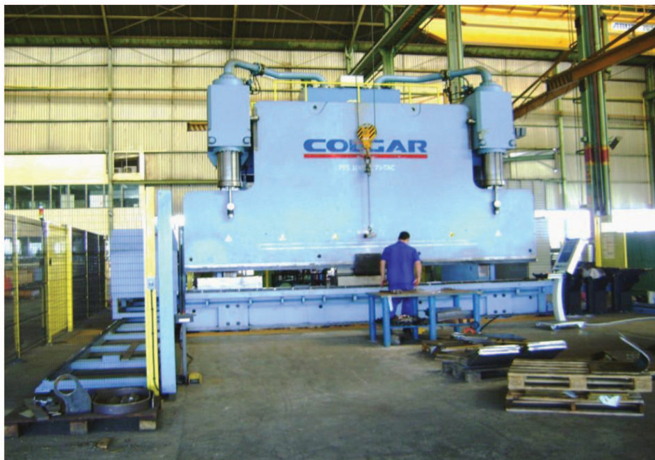
Figura 14 - Sistema de dobra CNC para o processo de manufatura Fonte: a EMPRESA
