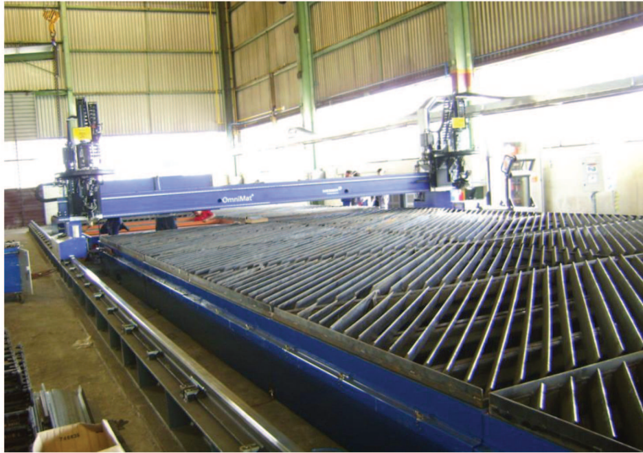
Figura 13 - Processo de corte Plasma para chapas de aço carbono Fonte: a EMPRESA
