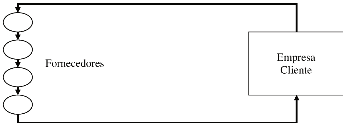
Figura 10 - Sistema de coleta Milk Run Fonte: o AUTOR
