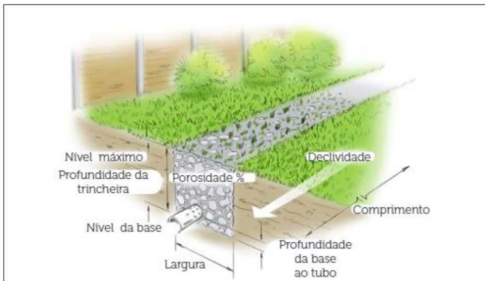
Figura 14: Bacias e trincheiras de percolação
