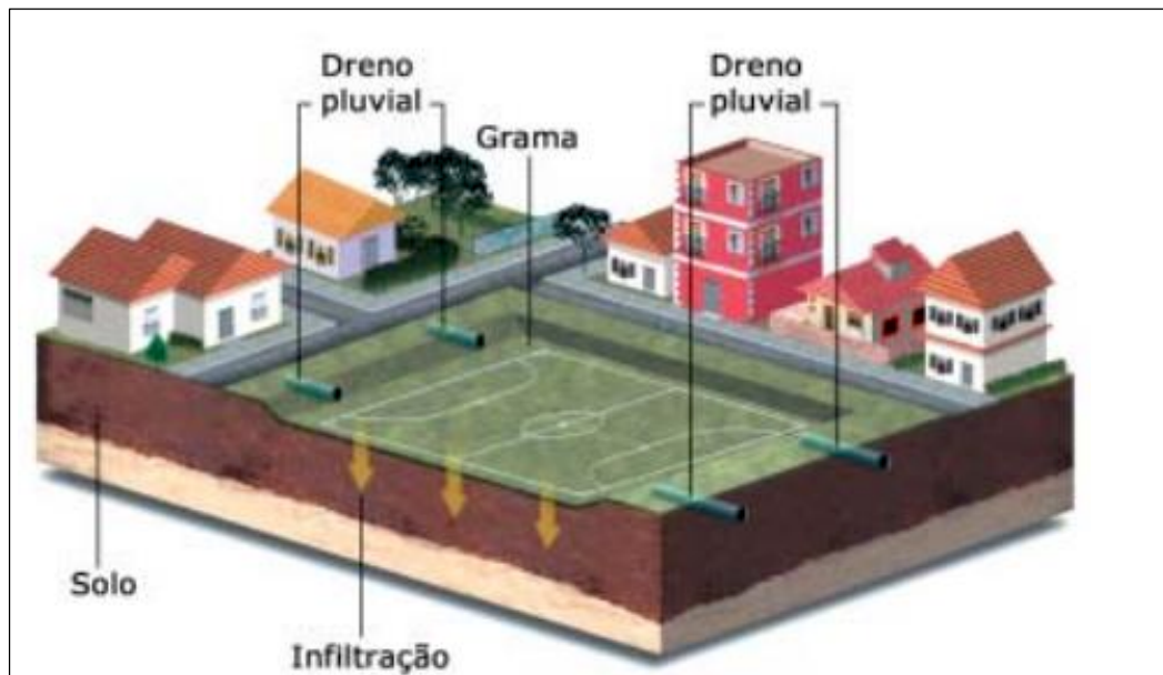
Figura 16: Campo de futebol utilizado no período de chuva para amortecimento da cheia.
