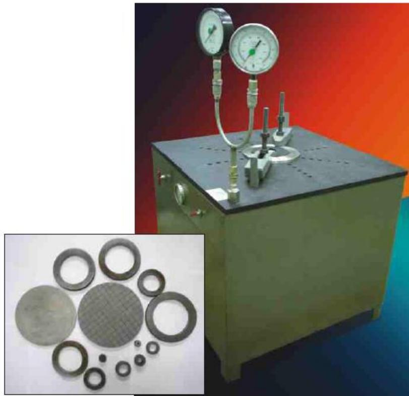
Figura 7 Bancada de teste com dois manômetros recomendada pela Petrobrás e acessórios
