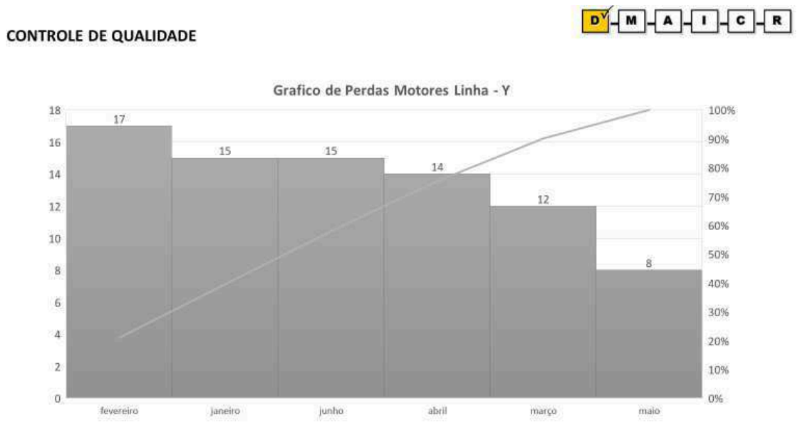
Figura 10 - Pareto de perdas de motores refugados pela incorreta gravação do número do motor no bloco Linha - Y
