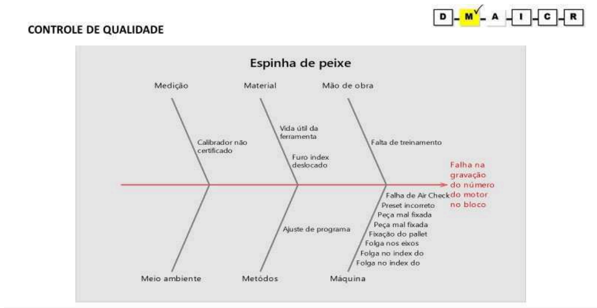
Figura 14 - Espinha de peixe para falha de gravação do número do motor no bloco - estação 20 da linha W
