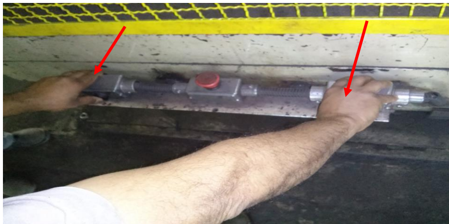
Figura 4. Comando bimanual de acionamento. Fonte: Empresa Y, 2017.
