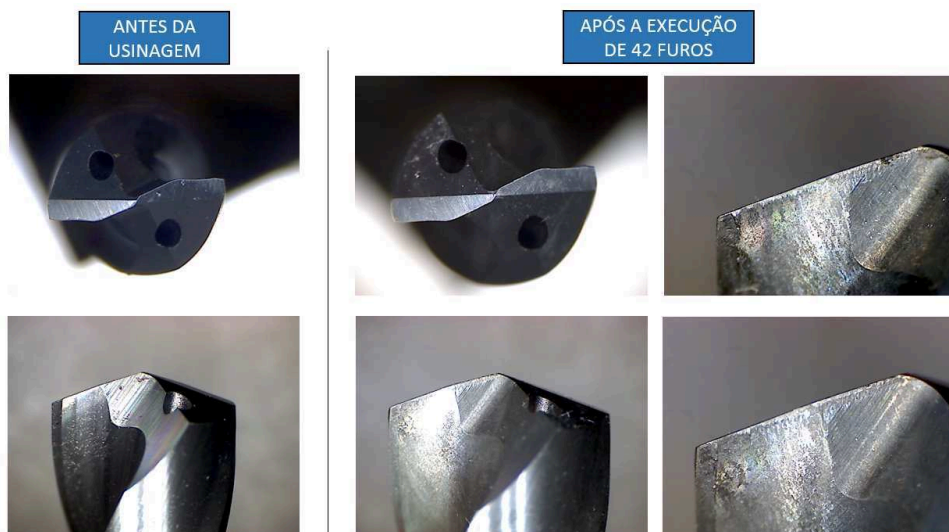
FIGURA 30 – ASPECTO VISUAL DA FERRAMENTA NO TESTE #2
