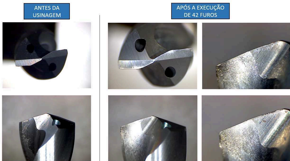
FIGURA 45 – ASPECTO VISUAL DA FERRAMENTA NO TESTE #7
