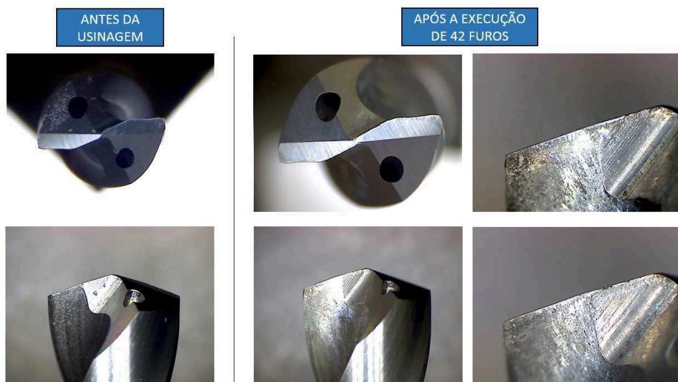
FIGURA 39 – ASPECTO VISUAL DA FERRAMENTA NO TESTE #5
