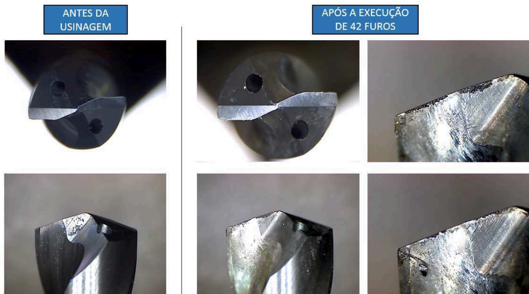
FIGURA 33 – ASPECTO VISUAL DA FERRAMENTA NO TESTE #3
