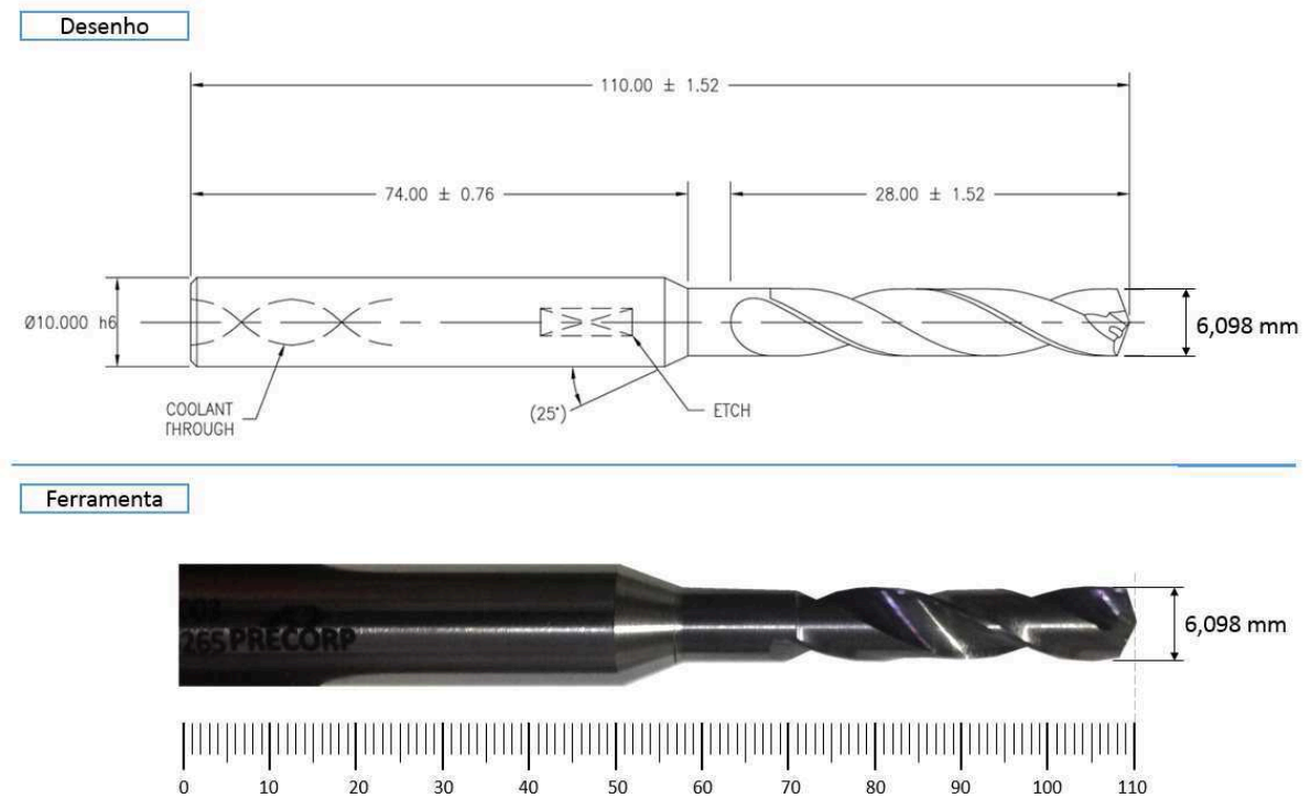
FIGURA 20 – DIMENSÕES DA FERRAMENTA DE CORTE
