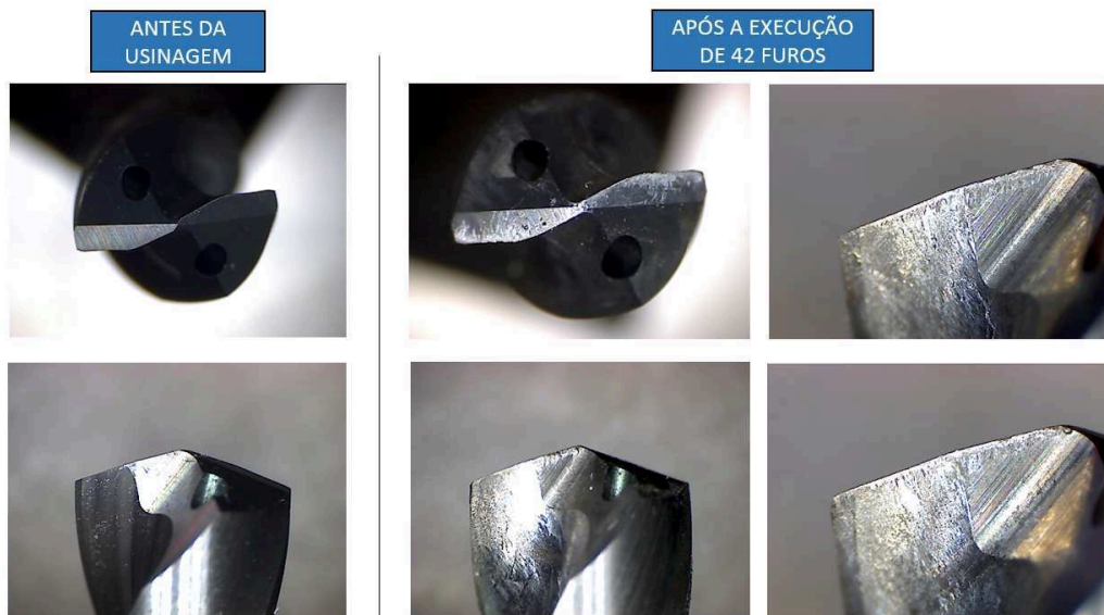
FIGURA 51 – ASPECTO VISUAL DA FERRAMENTA NO TESTE #9
