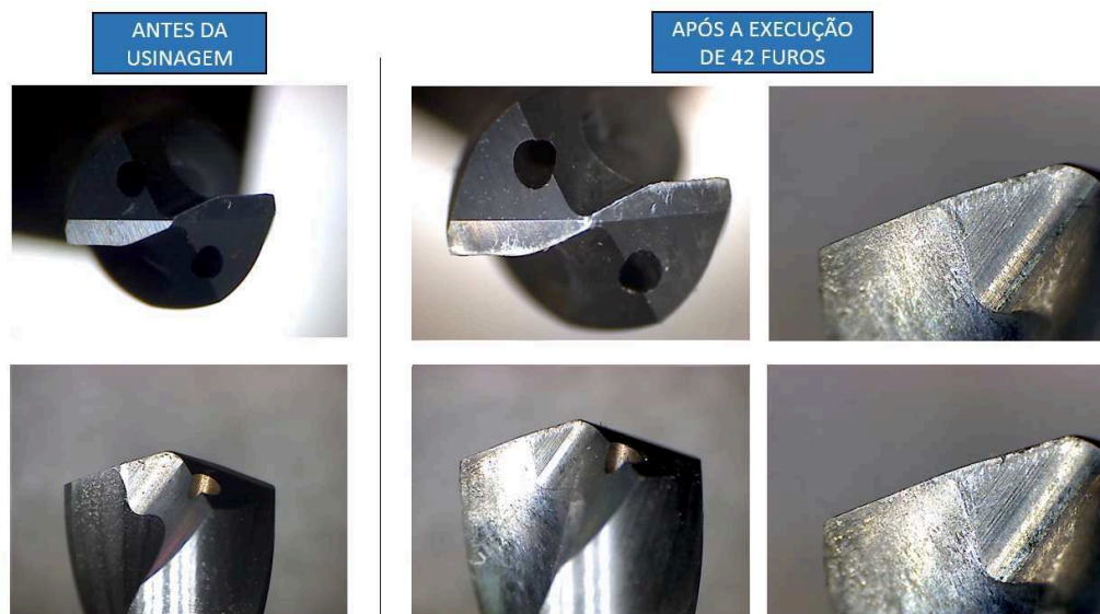
FIGURA 48 – ASPECTO VISUAL DA FERRAMENTA NO TESTE #8
