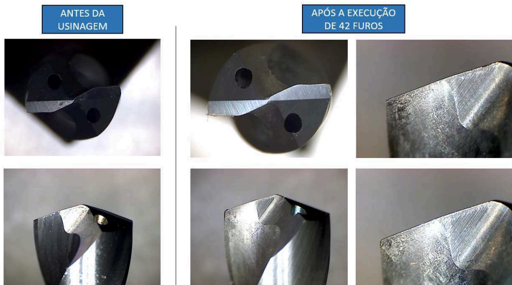
FIGURA 36 – ASPECTO VISUAL DA FERRAMENTA NO TESTE #4
