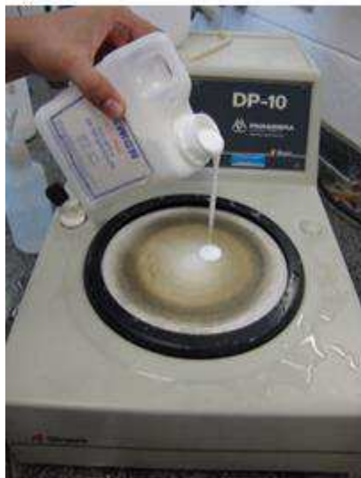
Figura 18 - Polimento das amostras
