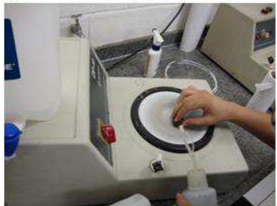
Figura 18 - Polimento das amostras
