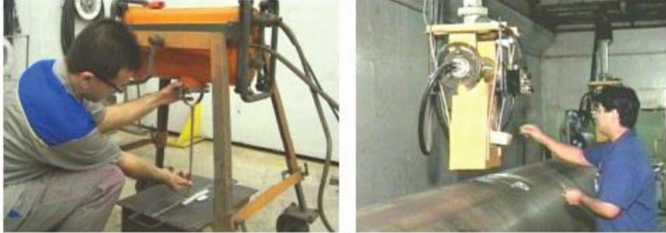
Figura 12 - Inspeção radiográfica de soldas (CONFAB)
