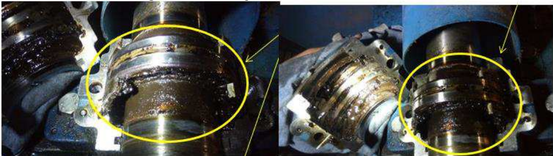
Figura 27 - Oxidação da Graxa no Rolamento
