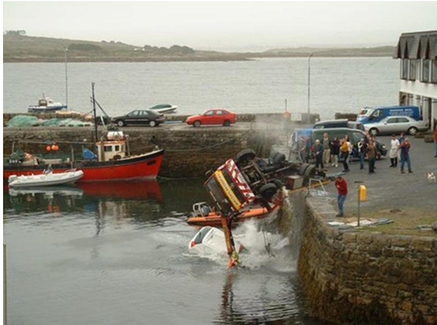
Fig. 78 – Acidente no içamento de veículo.
