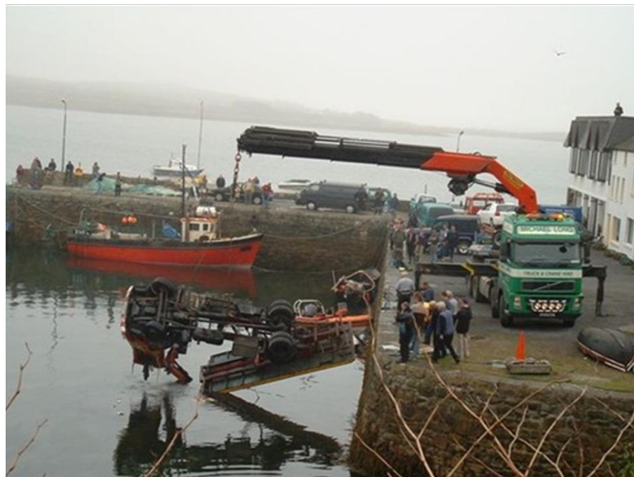
Fig. 79 – Acidente no içamento de veículo.
