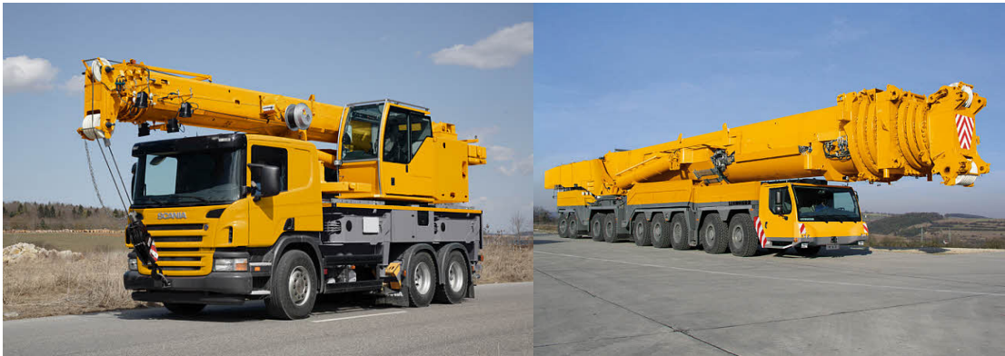
Fig. 12–Guindaste hidráulico sobre caminhão Fonte: (LIEBHERR, 2008)
