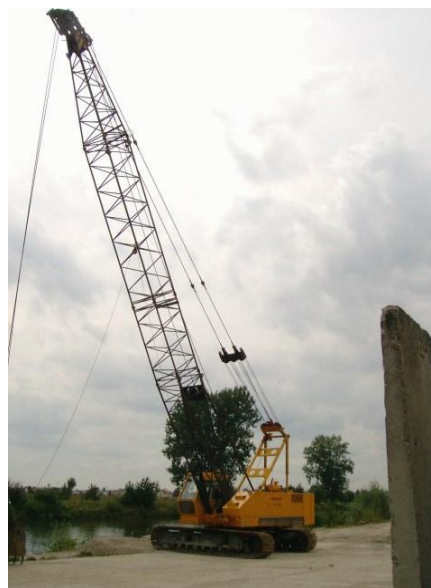
Fig. 5 –Guindaste treliçado sobre esteiras Fonte: (LOCAR, 2008)
