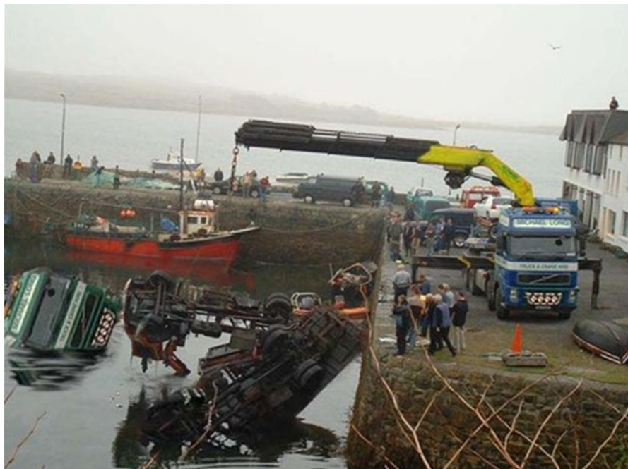
Fig. 81 – Acidente no içamento de veículo.
