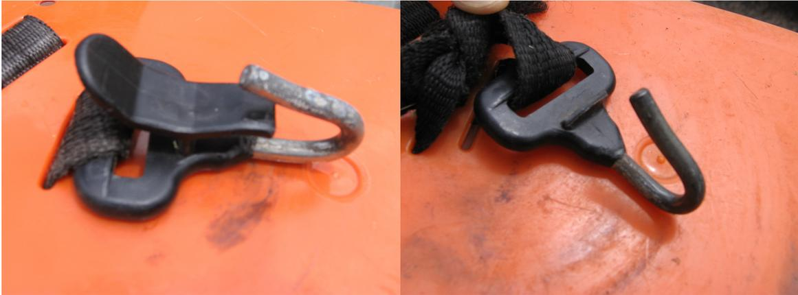
Figura 20 – Mecanismo de segurança da alça da roçadeira e mecanismo danificado.
