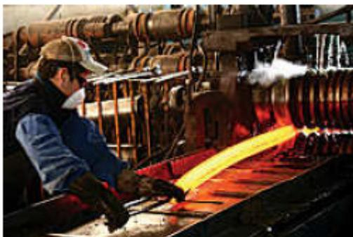
Figura 3 Trabalhador realizando atividade de laminação
