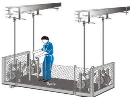
Figura 11 Andaime suspensos mecânico pesado
