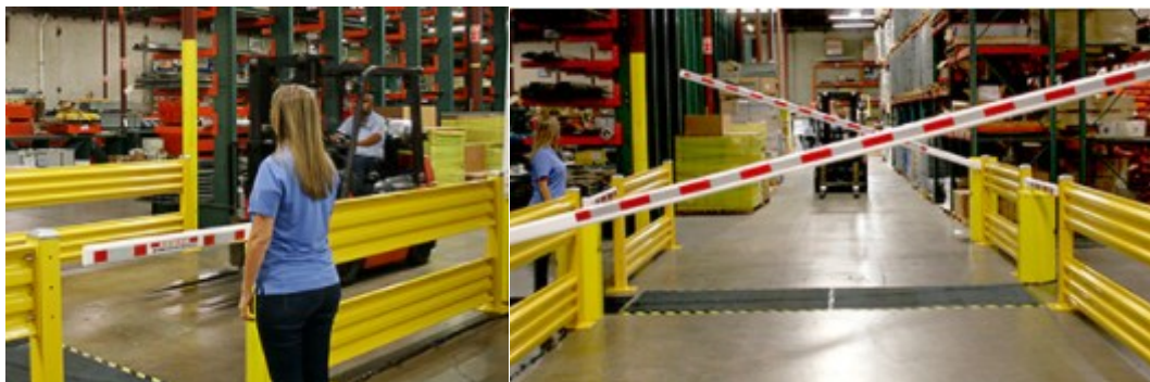
Figura 6 Sistema de corredores para pedestres e ilhas de operação de empilhadeiras. Fonte: Cisco-Eagle: Material Handling Solutions & Conveyor Systems 2017
