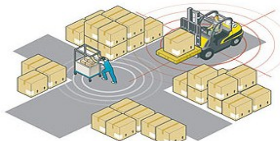
Figura 5 Sistema de proximidade para empilhadeiras
