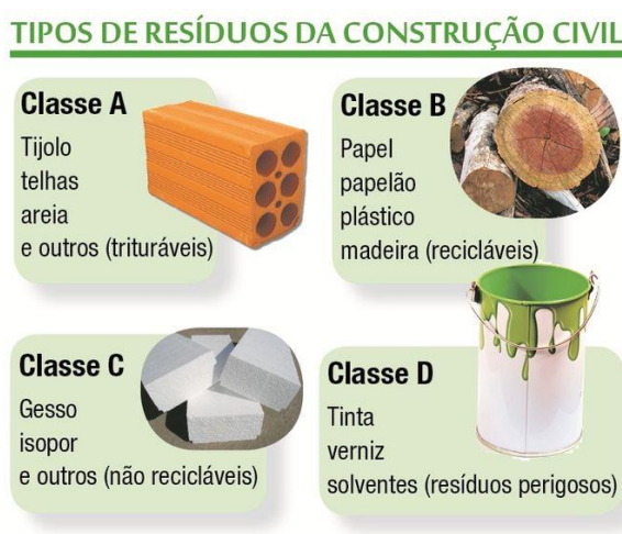
Figura 22 — Categoria de Resíduos na Construção Civil
