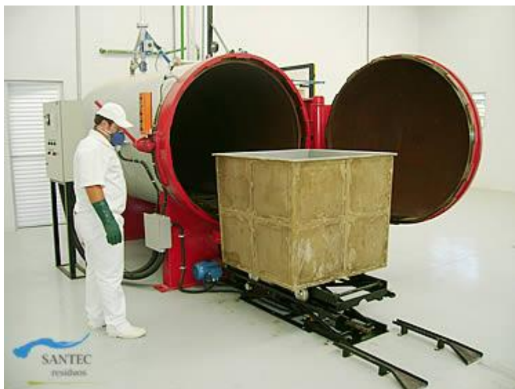
Figura 4 – Autoclave em operação - empresa Santec
