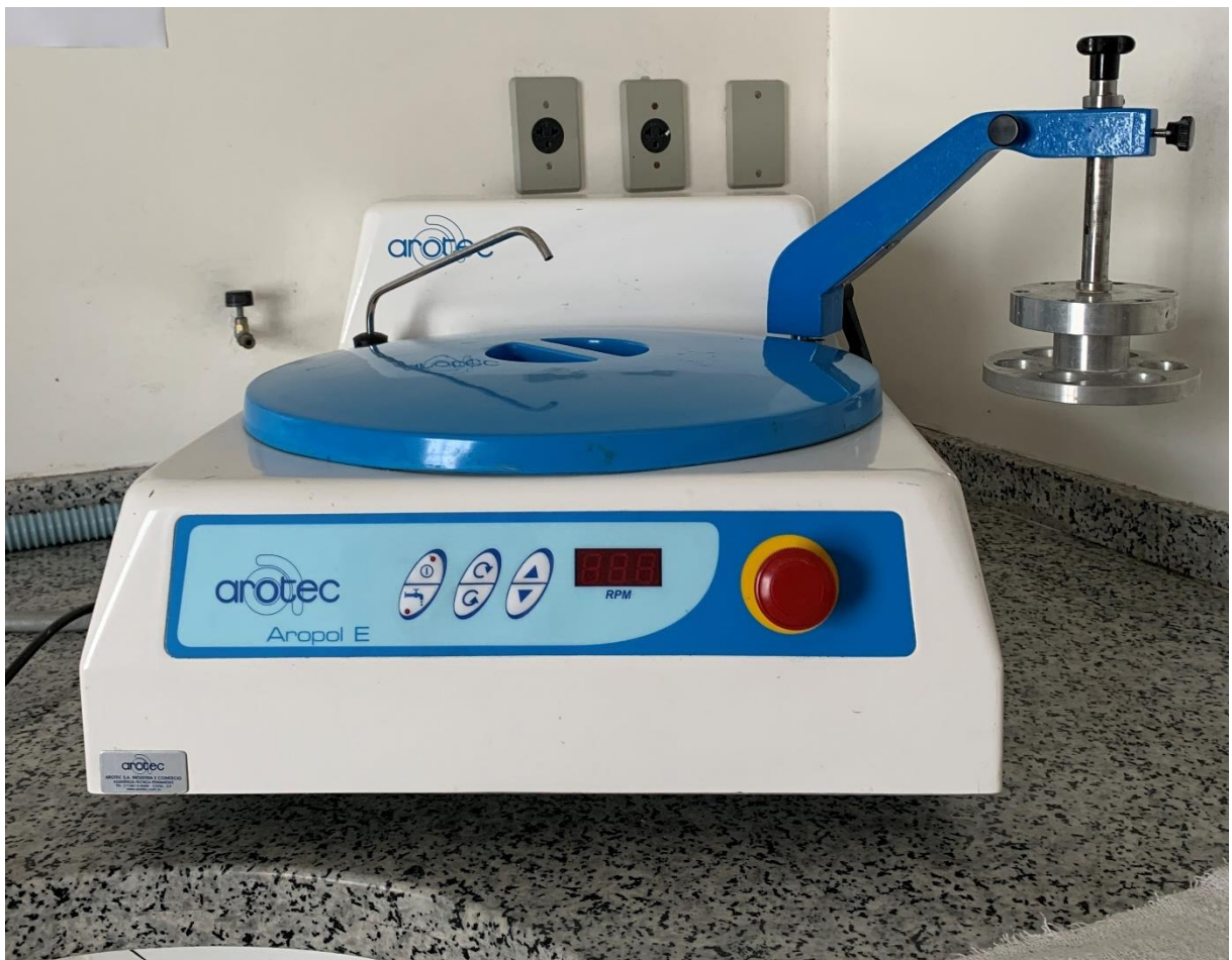
FIGURA 3 – Politriz circular onde as amostras foram planificadas e polidas com velocidade de 600rpm.
