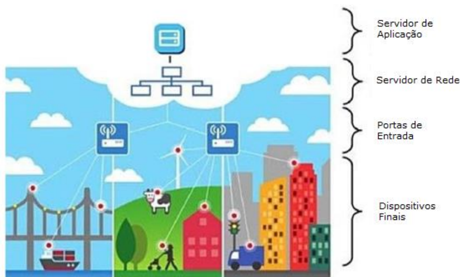
Figura 2.2 – Arquitetura de uma rede LoRaWAN.
