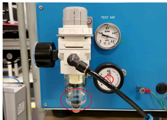
Figura 6: Filtro de ar contaminado com água
