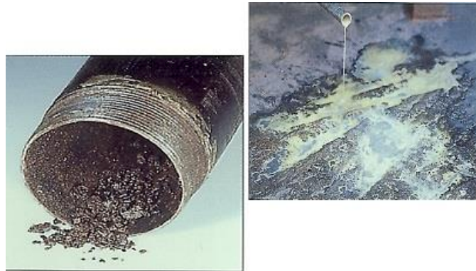
Figura 10: Danos sofridos na linha pneumática
