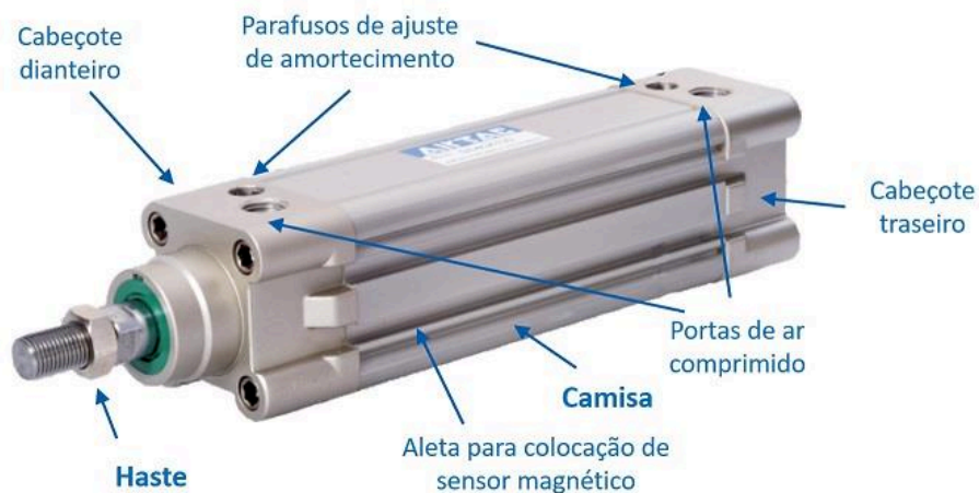
Figura 8: Componentes de um cilindro pneumático
