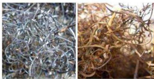
Figura 16. Saturação de limalha de ferro após tempo de uso
