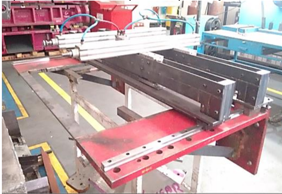
Figura 14 – Implementação do alimentador pneumático para avançar o final de bobina
