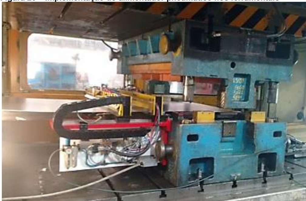
Figura 20 – Implementação do alimentador pneumático nos ferramentais
