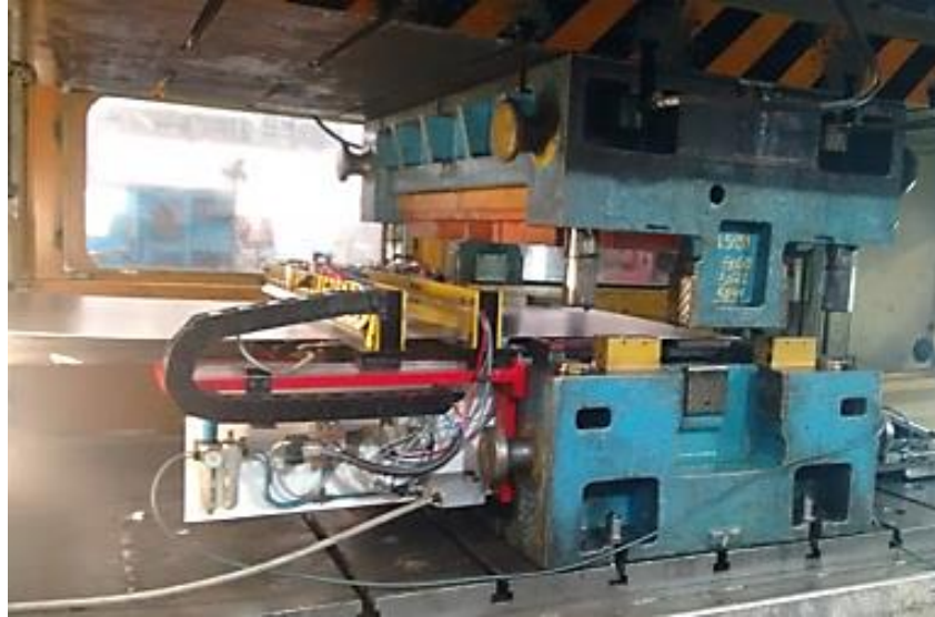
Figura 16 – Padronização do alimentador pneumático para atender a varias ferramentas
